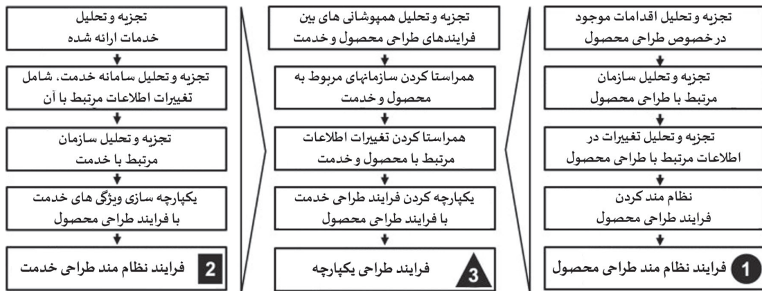
تصویر ۵. فرایند طراحی پی. اس. اس. که در روش شناسی اوریج پیشنهاد شده است (Vijaykumaret al, 2012: 646)
