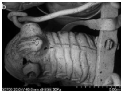
تصویر ۵- جزئیات لحیم‌کاری شده‌ی شکاف‌های متصل ورقه‌های طلائی اشکال (a) سَرِ مسافر و (b) یال یکی از اسبها.
