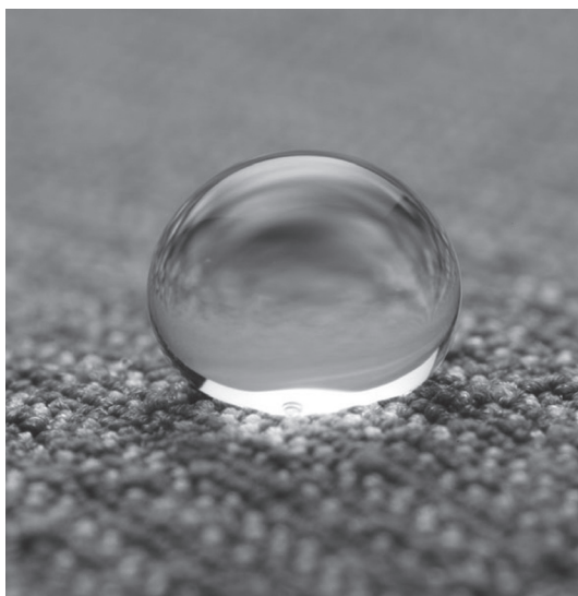
تصویر ۱: نحوه قرار گرفتن قطره آب و روغن بر سطح پارچه اندودشده با نانوسفیر www.schoeller-textiles.com/en/technologies/nanosphere.html ; www.quality-fabrics.com/mattress-ticking/mattress-nanosphere.php
