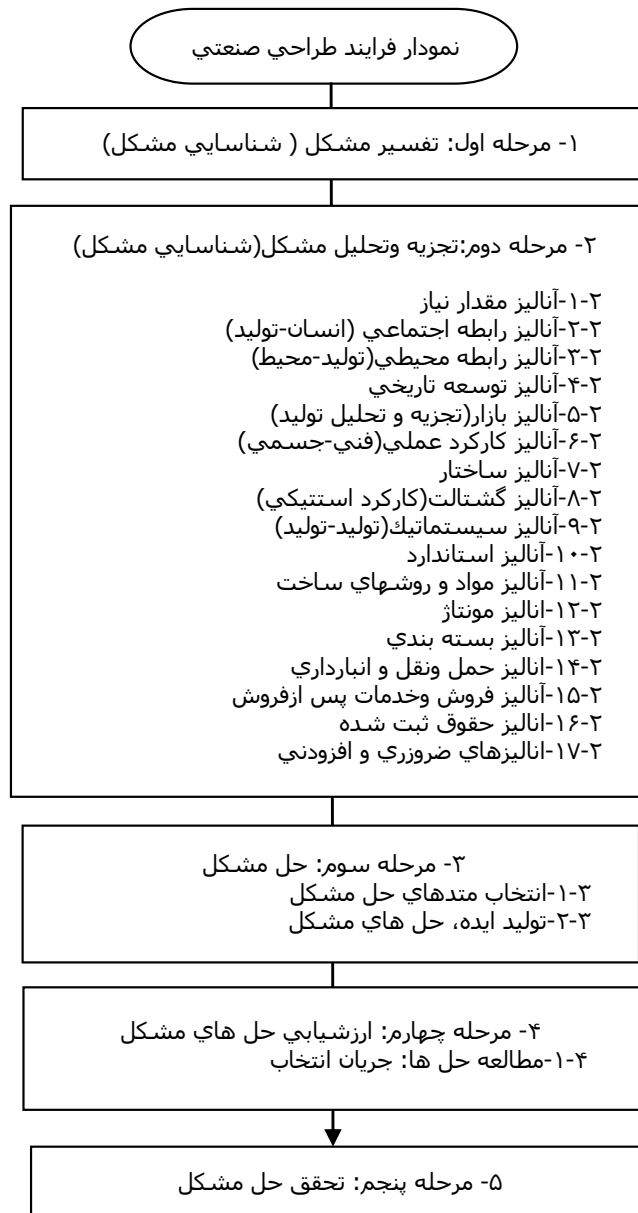
شکل ۷: مدل فرایند طراحی صنعتی بر مبنای تئوری‌های دروس مربوط (حاجتی مدارائی، ۱۳۷۵: ص ۹-۴۳) (تنظیم نمودار: نگارنده)
